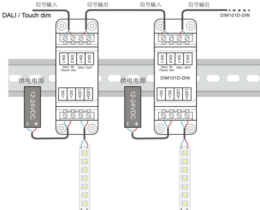
备注: 只能使用开路的按压式开关 (不带指示灯)。采用同步连线时每个设备和设备之间的线长不超过 20 米。
