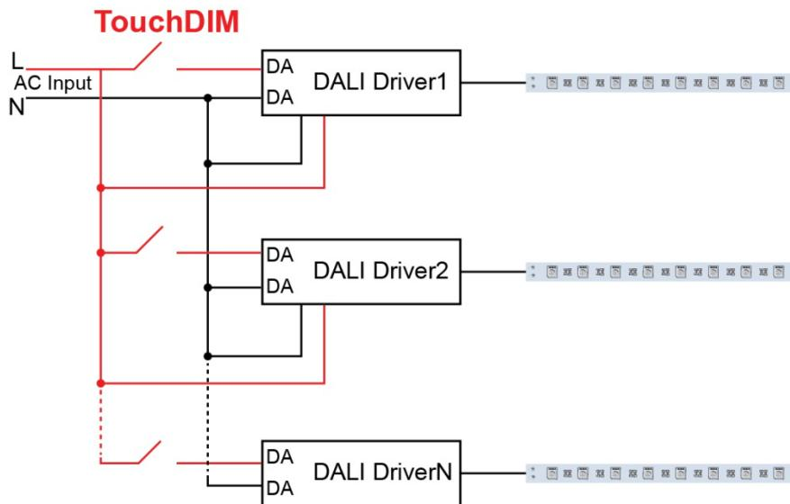
备注:只能使用开路的按压式开关(不带指示灯)。采用同步连线时每个设备和设备之间的线长不超过 20 米。
