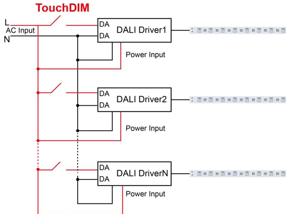
备注: 只能使用开路的按压式开关 (不带指示灯)。采用同步连线时每个设备和设备之间的线长不超过 20 米。
